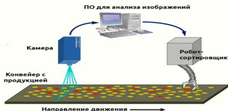
Рис. 14. Производственная линия с машинным зрением
