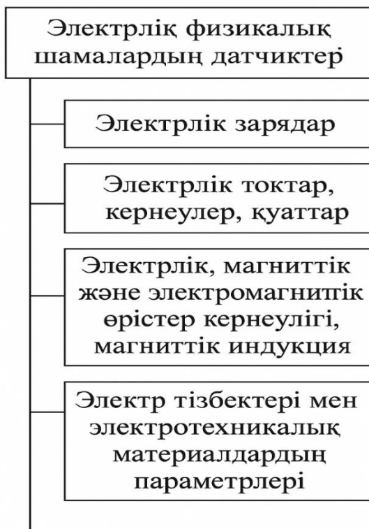
Сурет 1.6. Датчиктерді өлшенетін электрлік шамалар түріне қарай жіктеу
