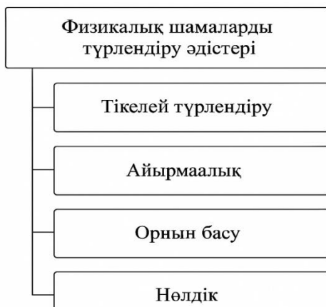
Сурет 1.8. Датчиктерде қолданылатын түрлендіру әдістері
