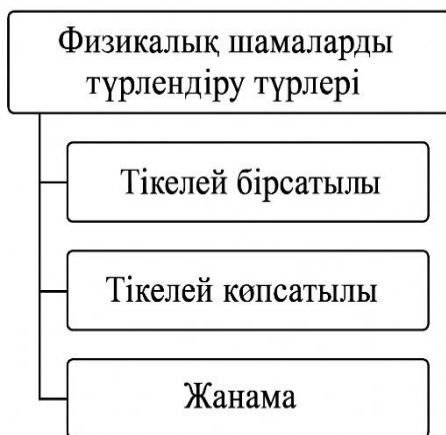
Сурет 1.7. Физикалық шамаларды түрлендіру әдістері бойынша датчиктердің классификациясы
