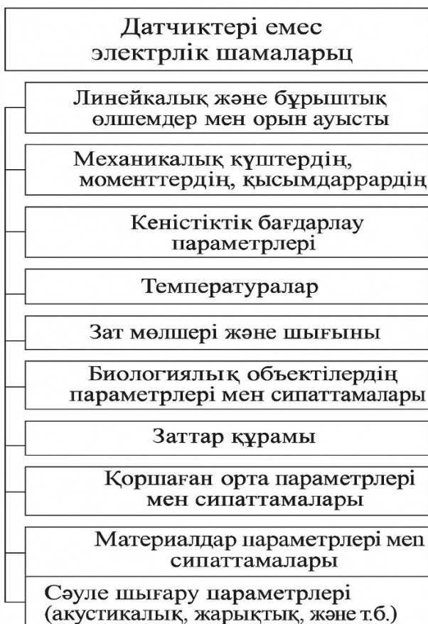
Сурет 1.5. Датчиктерді өлшенетін электрлік емес шамалар түріне қарай жіктеу
