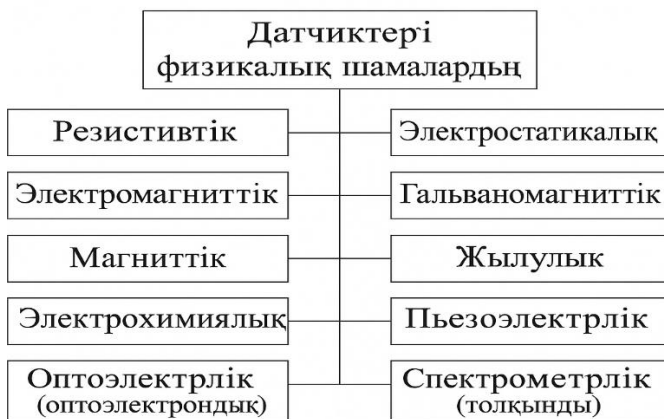
Сурет 1.4. Датчиктерді әрекет принципі бойынша жіктеу
