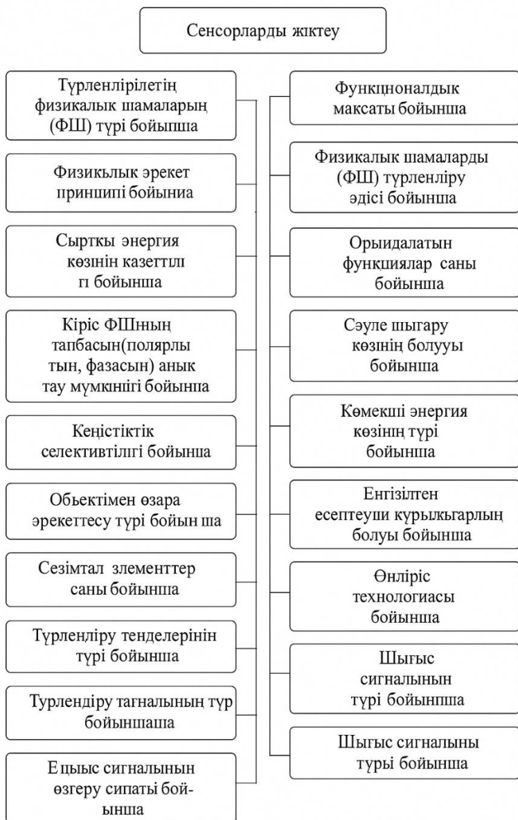
Сурет 1.3. Өлшеу түрлендіргіштерін кіріс және шығыс шамалар түріне қарай жіктеу
